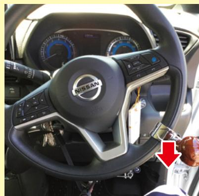
ハンドルに取り付けるノブのような回旋装置を、手のひらで押さえつけるようにして持つことで、ハンドルを回す操作が片手で容易にできるもの。
